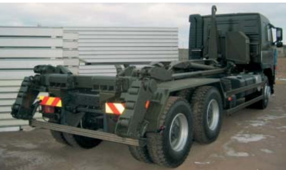
Hakowy system załadowniczy, zdecydowanie podnosi elastyczność oraz efektywność wykorzystania pojazdu
