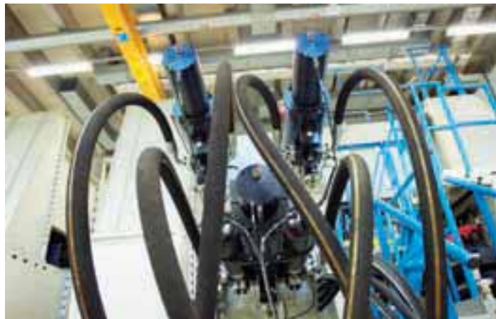
Die Anlage verfügt insgesamt über 24 Hydraulikzylinder, sechs pro Rad, die die Belastung des Fahrens auf der Straße simulieren. Die Kraft kann vertikal entlang der zu prüfenden Achse oder seitlich ausgeübt werden.
