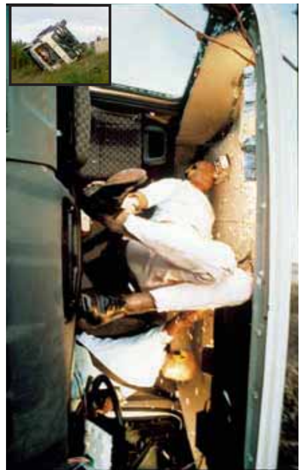
Wer umkippt, fällt hart. Das Bild zeigt einen Test, bei dem man einen Lkw einen Abhang herunterrollen ließ. Einige Sekunden nach Beginn der Aufnahme durchbrach der unangeschnallte Dummy die Frontscheibe. Von den aus der Kabine geschleuderten Fahrern erleiden 74 Prozent schwere oder tödliche Verletzungen.
