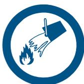
Para reduzir o risco de aumento na pressão no depósito, arrefecer o depósito de GNC com água.
